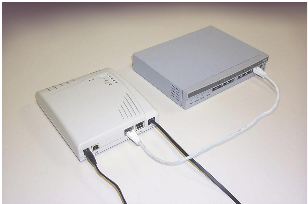
Σχ. 21: Σύνδεση του jetSpeed 500/500i με ένα δίκτυο (μέσω HUB).
