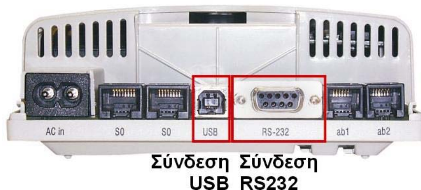
Εικόνα 10: Σύνδεση Η/Υ
